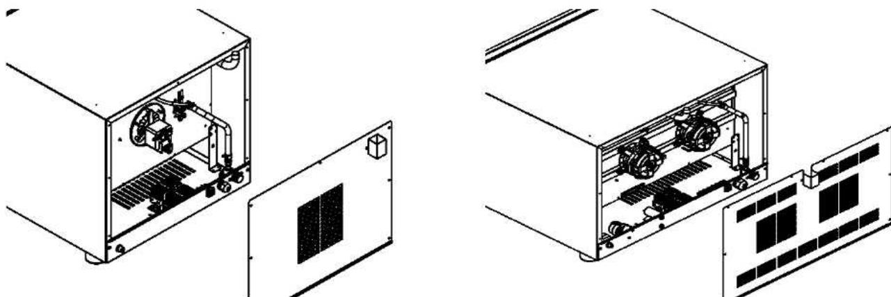
Снимите заднюю панель оборудования и найдите клеммную колодку.
