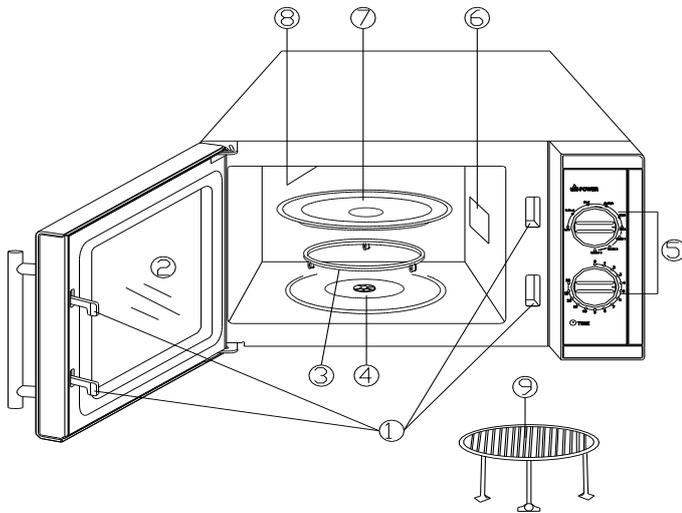
**Рис.1. Основные узлы оборудования**
