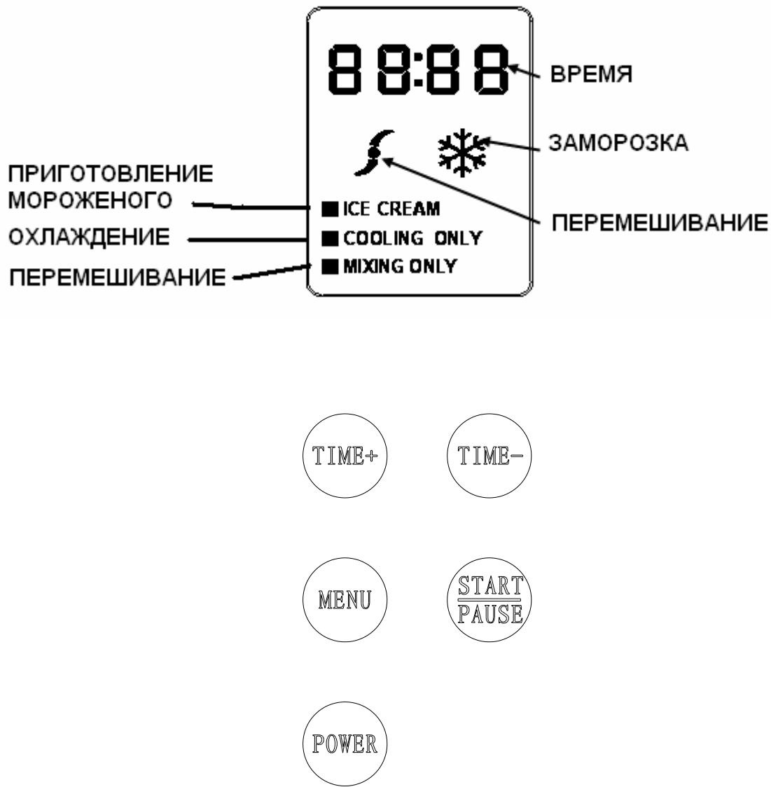
**[POWER «ВКЛ/ВЫКЛ» ]:** После подключения фризера к электросети, аппарат перейдет в режим ожидания и на дисплее появиться «00». Нажмите кнопку [POWER], чтобы перейти к выбору настроек. Если Вы нажмете кнопку [POWER] во время работы фризера, то он выключиться.
