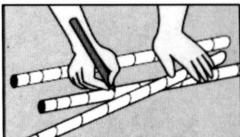
2.1. При помощи маркера отметьте на каждой стойке положение полки.
