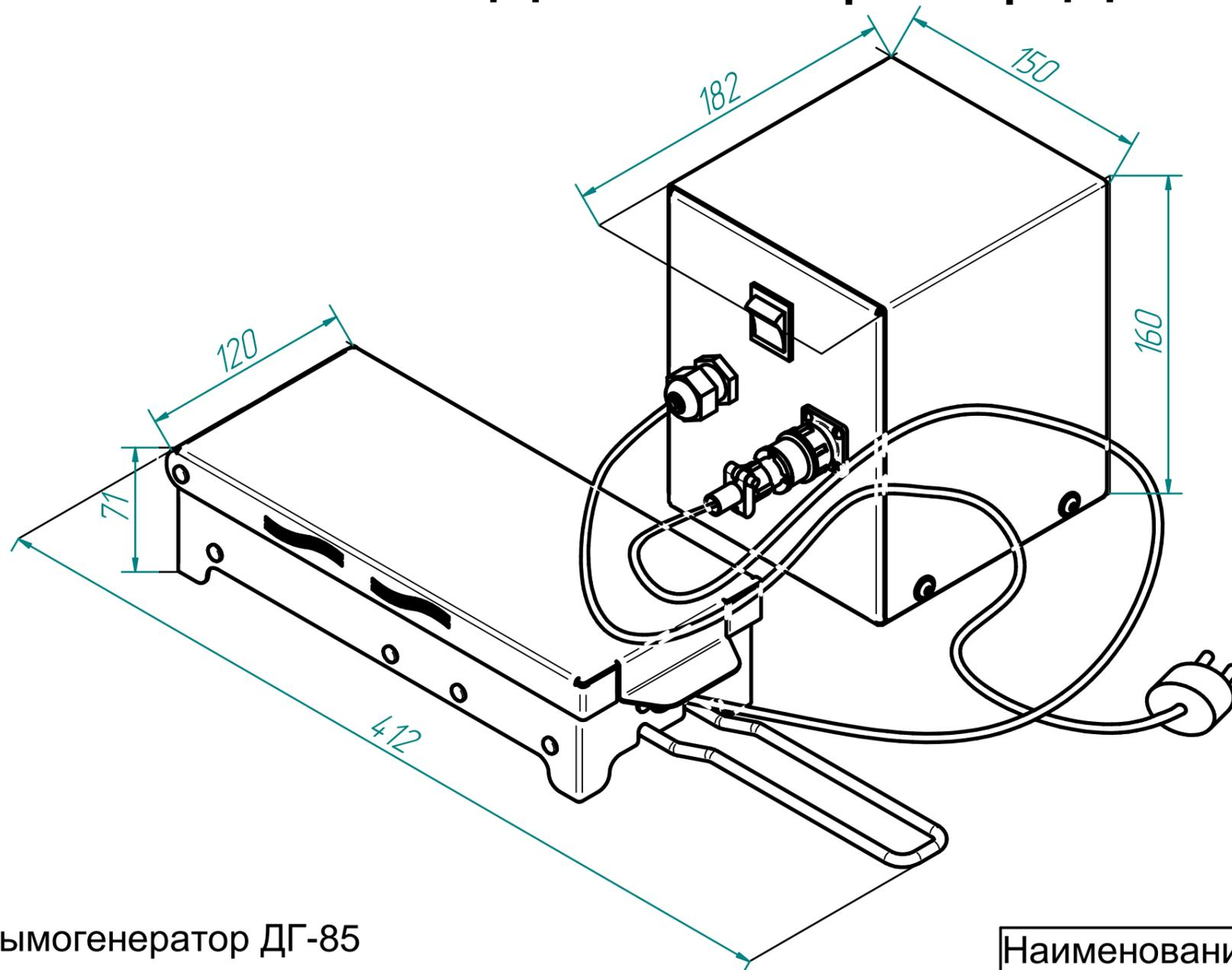
Дымогенератор ДГ-85 предназначен для копчения продуктов питания во всех типоразмерах пароконвектоматов производства АО "Чувашторгтехника" и ООО "Элинокс".
