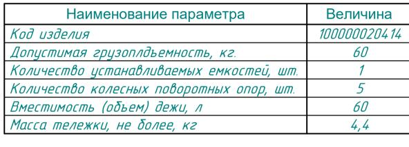
Тележка МПЛ-60.19529.17предназначена для перемещения, установки и снятия дежи на миксер планетарный МПЛ-60.
