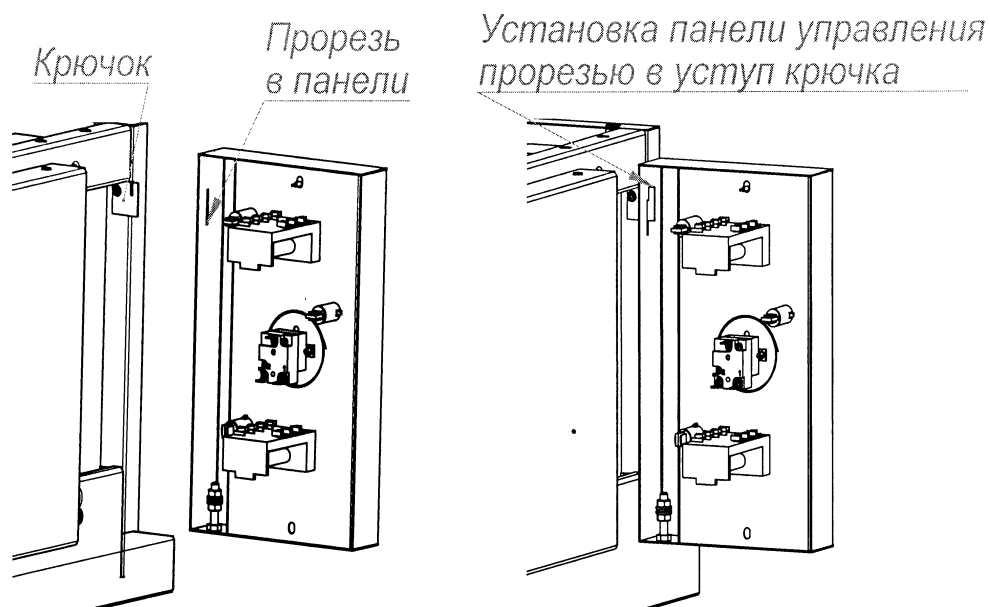
Рис. 4 Схема установки панели управления при ТО
