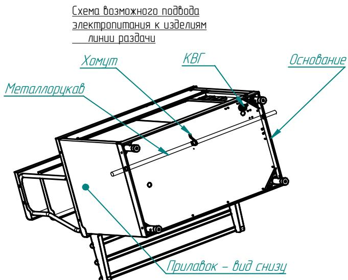
В основаниях изделий линии раздачи введено сквозное отверстие диаметром 29,5 мм и поддерживающие хомуты для возможности проведения металлической скобы с питающими кабелями сквозь все изделия линии раздачи.
