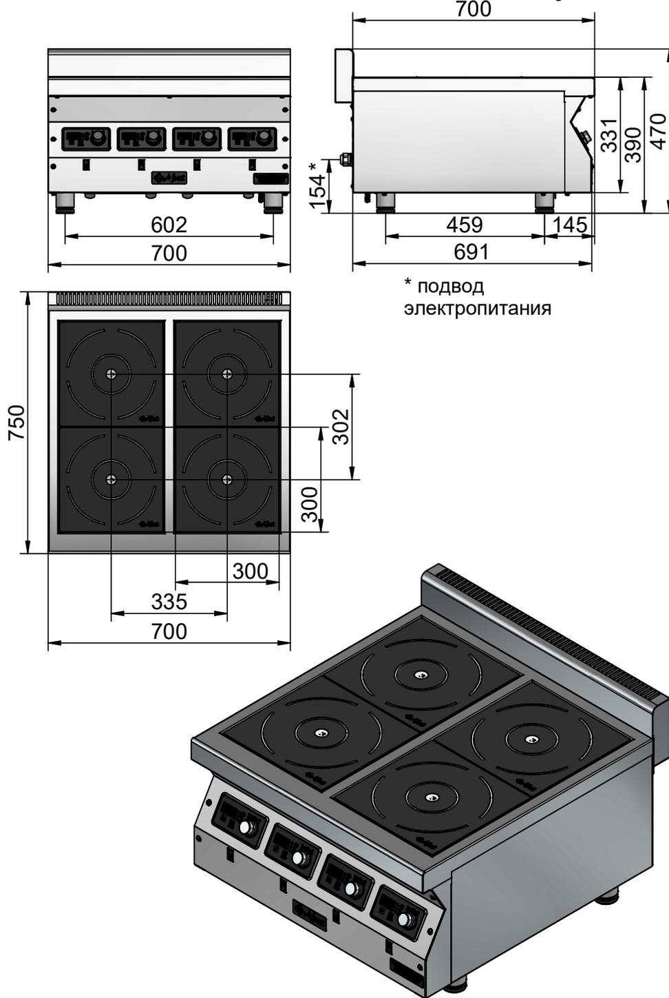
Плита индукционная кухонная настольная **КИП-47Н-3,5** предназначена для приготовления первых, вторых и третьих блюд в специальной наплитной посуде.
