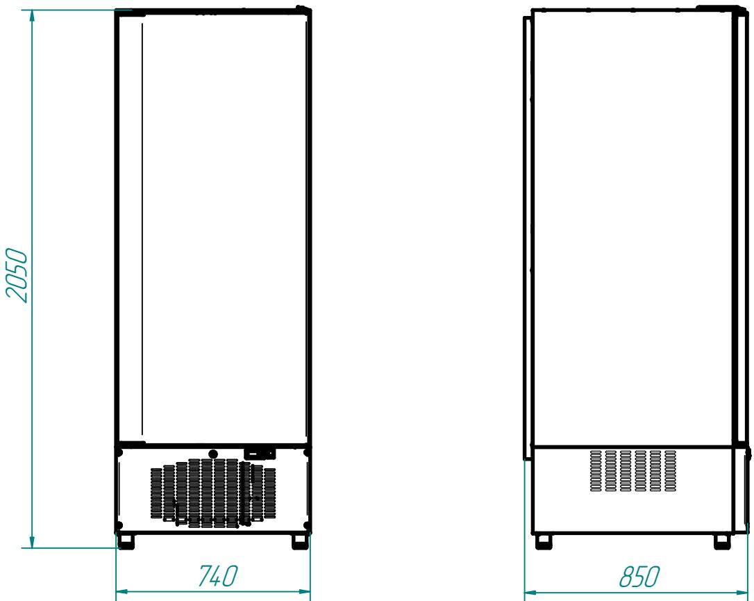
Шкаф холодильный типа ШХ-0,7 (ШХн-0,7;ШХс-0,7) с нижним расположением агрегата предназначен для хранения пищевых продуктов в охлаждённом или замороженном состоянии на предприятиях общественного питания и торговли.
